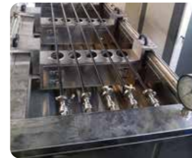
Equipo de detección de flujo para serie de productos de riego por goteo
